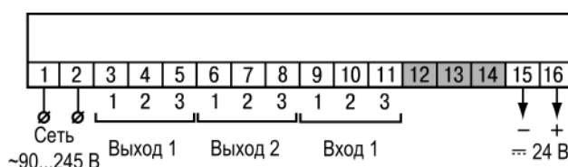
Рисунок 5.2 – Назначение контактов клеммной колодки прибора в настенном Н и щитовом Щ1, Щ2 типах корпусов
