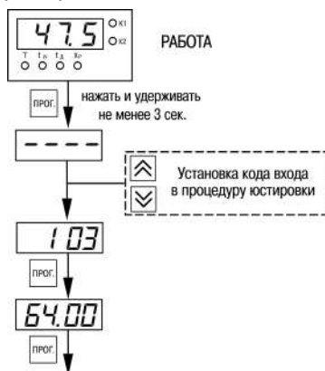
Рисунок 8.4 – Последовательность работы при юстировке
